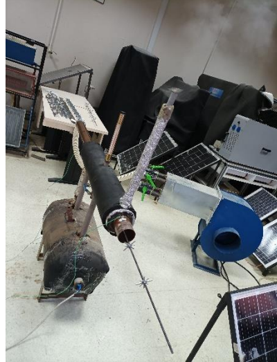
Şekil 5. Çubuk Silindirik Türbülötör Düzeneginin Isı Deęiřtiricisi İç Borusuna Yerleřtirilmesi
