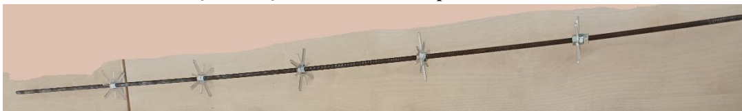
Şekil 3. Çubuk Silindirik Türbülatorlerin 15 cm Adımlarla 1 m’lik mil üzerine yerleştirilmesi
